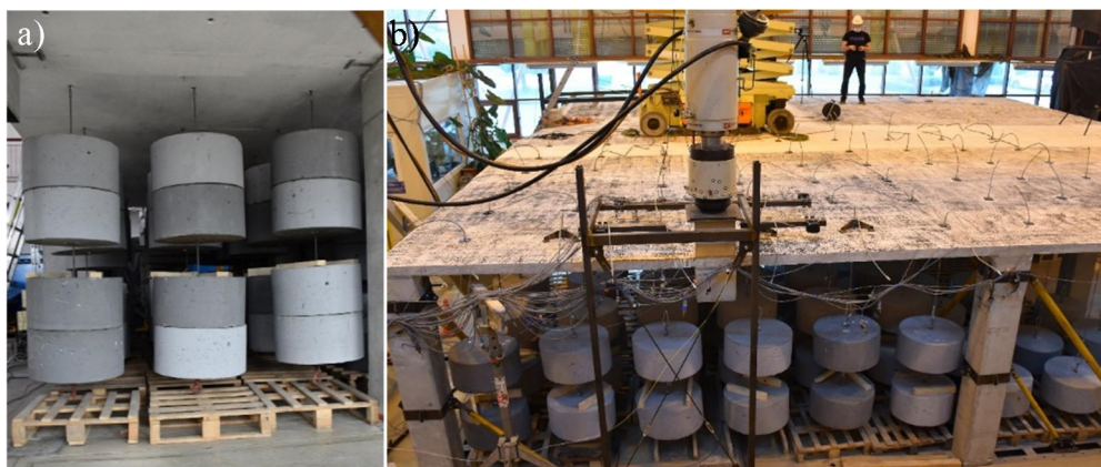
Rys. 3. Obciążanie stropu: a) widok obciążników b) obciążenie po usunięciu podpory.
